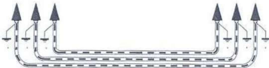
Figura 17: Puesta a tierra de cubiertas metálicas.
