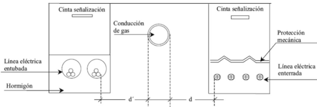
**Figura 25: Detalles de paralelismo y conducciones (ITC-LAT 06).**
