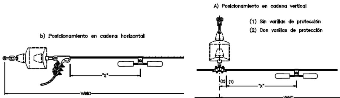
**Figura 18: Posicionamiento Antivibrador.**
