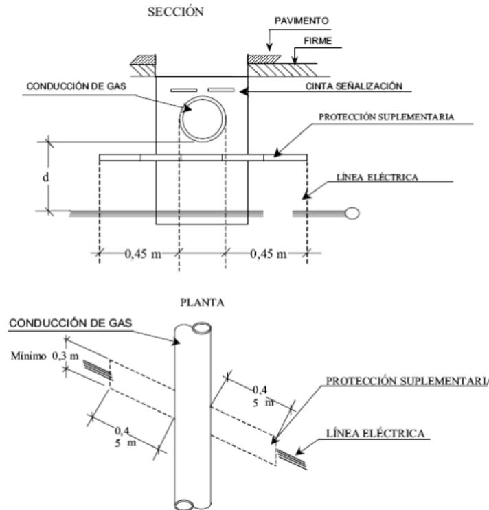
**Figura 23: Detalles de cruzamiento y conducciones (ITC-LAT 06).**
