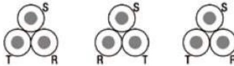
**Figura 20: Colocación de cables en tresbolillo.**
