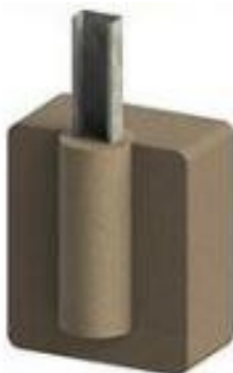
Imagen-croquis de cimentación con preperforación
