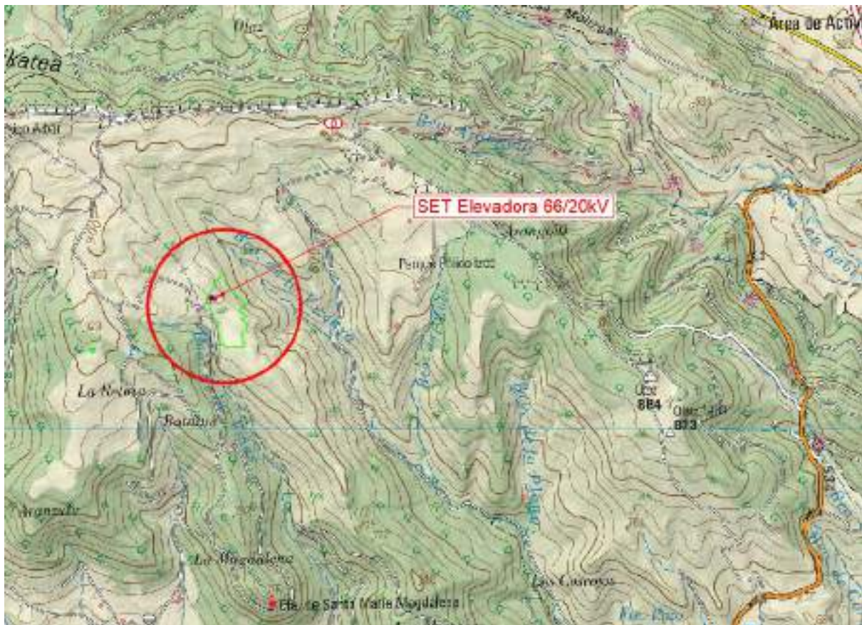
Figura 1: Localización Subestación Elevadora.
