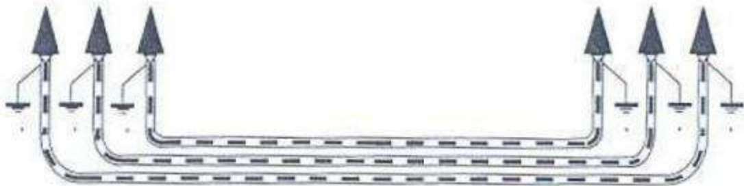
Figura 21: Puesta a tierra de cubiertas metálicas.
