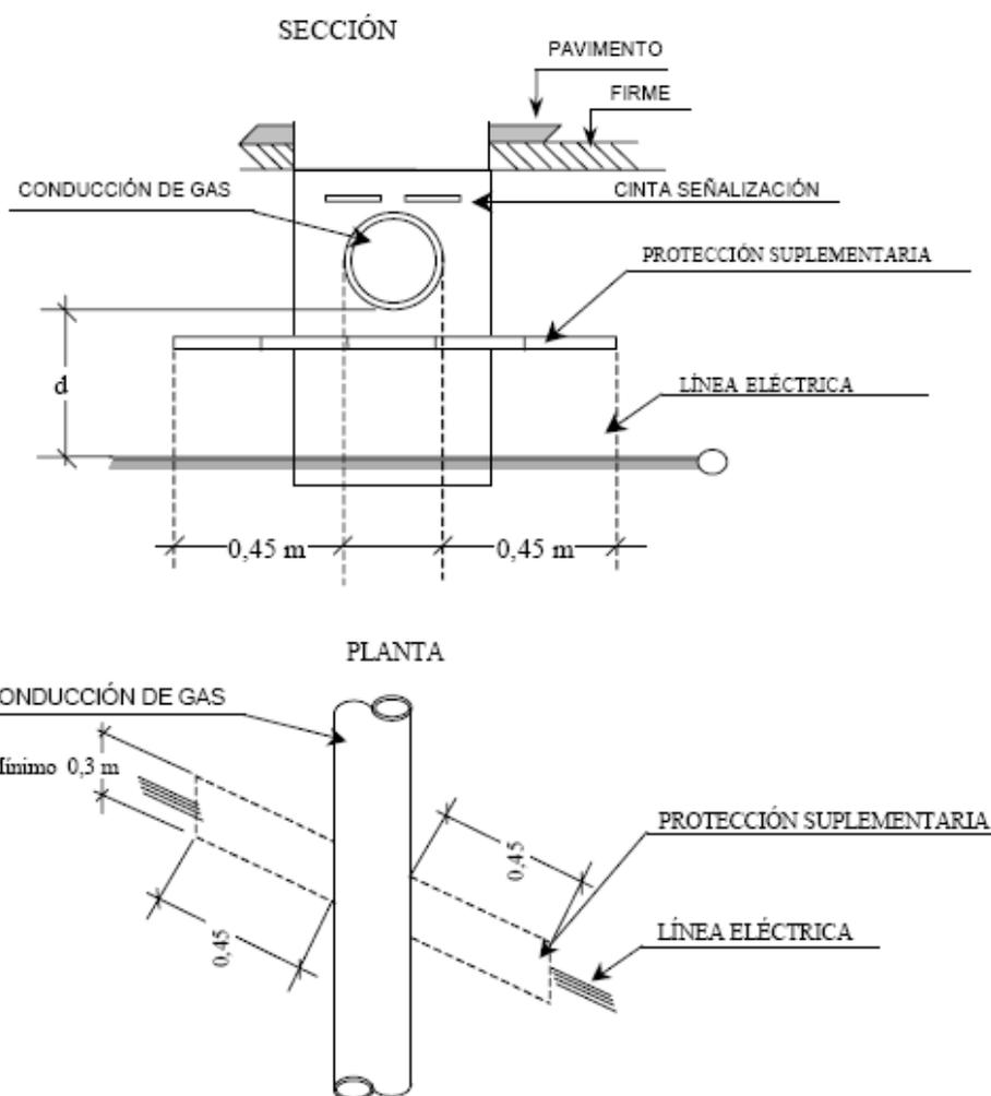
La protección suplementaria garantizará una mínima cobertura longitudinal de 0,45 m a ambos lados del cruce y 0,30 m de anchura centrada con la instalación que se pretende proteger, de acuerdo con la figura adjunta.
