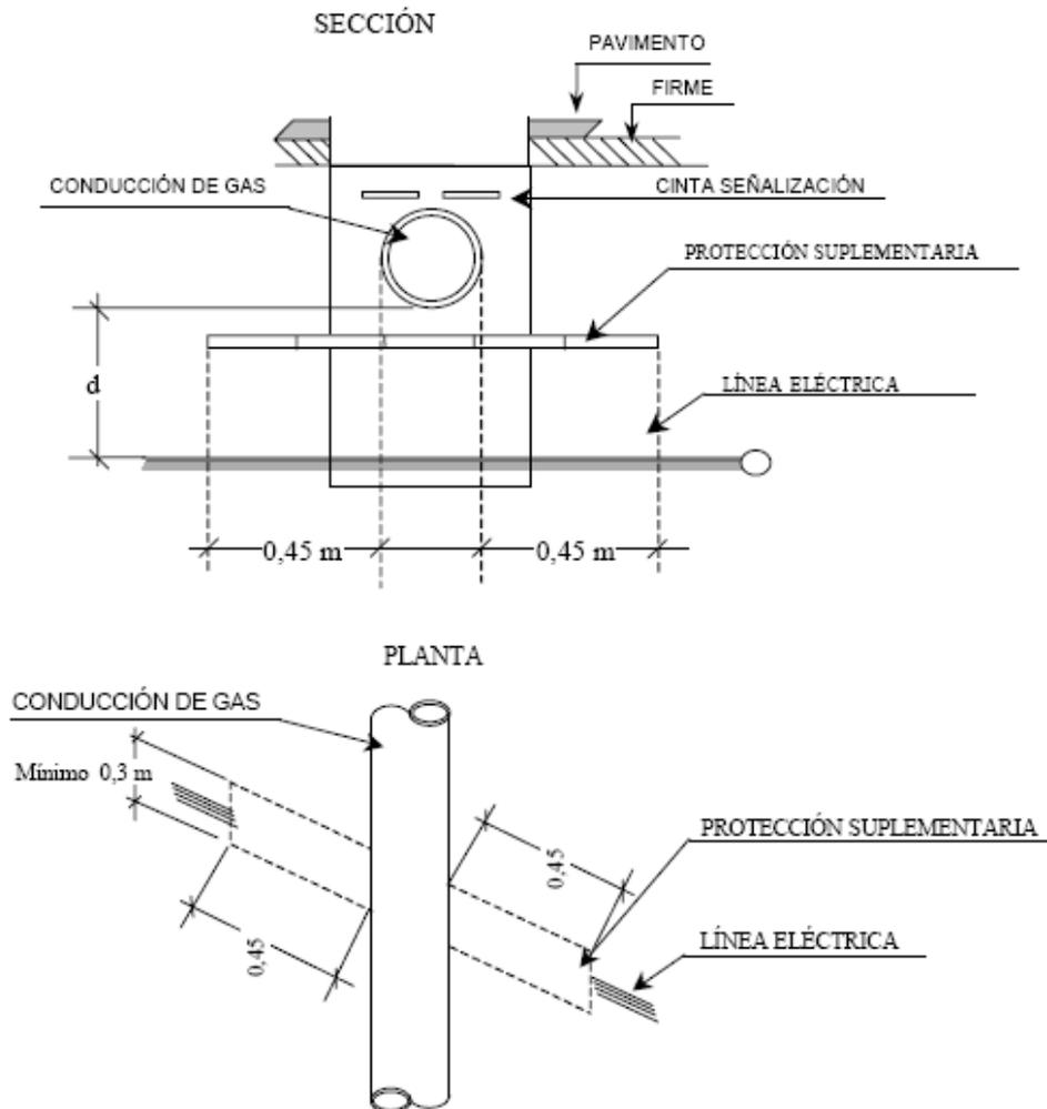
La protección suplementaria garantizará una mínima cobertura longitudinal de 0,45 m a ambos lados del cruce y 0,30 m de anchura centrada con la instalación que se pretende proteger, de acuerdo con la figura adjunta.
