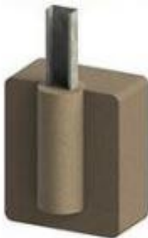
Imagen-croquis de cimentación con preperforación
