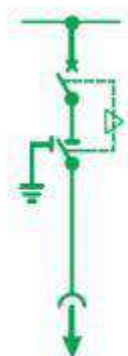
Unidad de protección del transformador
