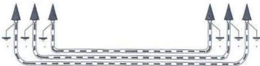
Figura 17: Puesta a tierra de cubiertas metálicas.
