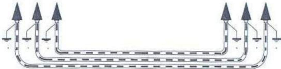
**Figura 13: Puesta a tierra de cubiertas metálicas.**
