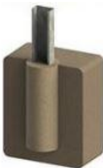
Imagen-croquis de cimentación con preperforación
