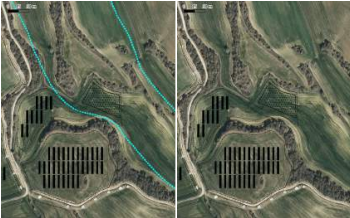
Imagen 26. Regatas al noreste de la Planta fotovoltaica Muruarte Solar I incluidas en la cartografía de IDENA (Gobierno de Navarra), pero que no se observan sobre el terreno o no coinciden con el cauce actual
