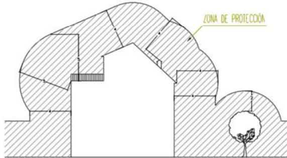
**NOTA:** Estas distancias mínimas serán radiales y se tienen que conservar en las condiciones más desfavorables de temperatura (aumento de flecha por calor o por manguito de hielo). En general, puede existir una variación del orden de 1 m. en la flecha de un conductor entre épocas de frío y de calor.
