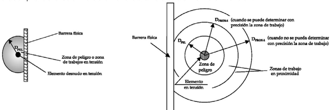
Si el elemento protector invade la zona de peligro su colocación requerirá trabajos sin tensión, o trabajos en tensión. En caso de ubicarse en la zona de proximidad se podrá colocar utilizando trabajos en proximidad.
