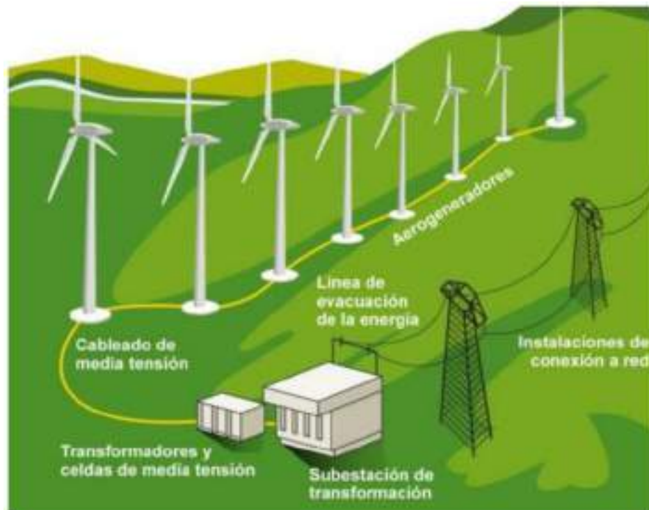
Imagen 3. Esquema de un Parque Eólico (Fuente: Greenpeace)
