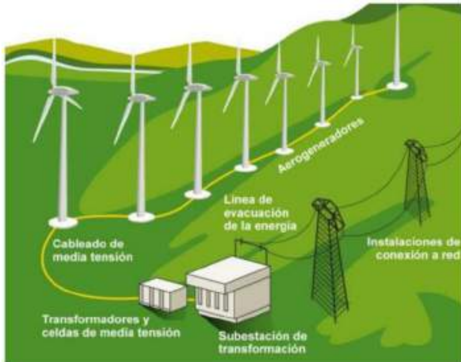
Imagen 3. Esquema de un Parque Eólico (Fuente: Greenpeace)
