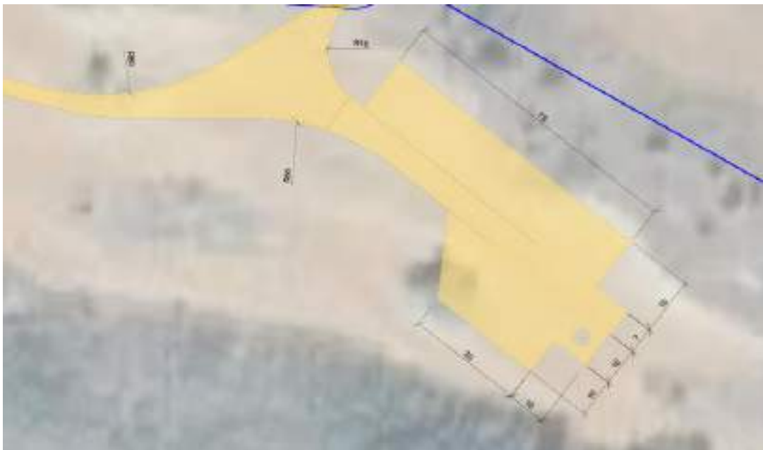
Imagen 8. Plataforma de montaje y zonas de acopio aerogenerador
