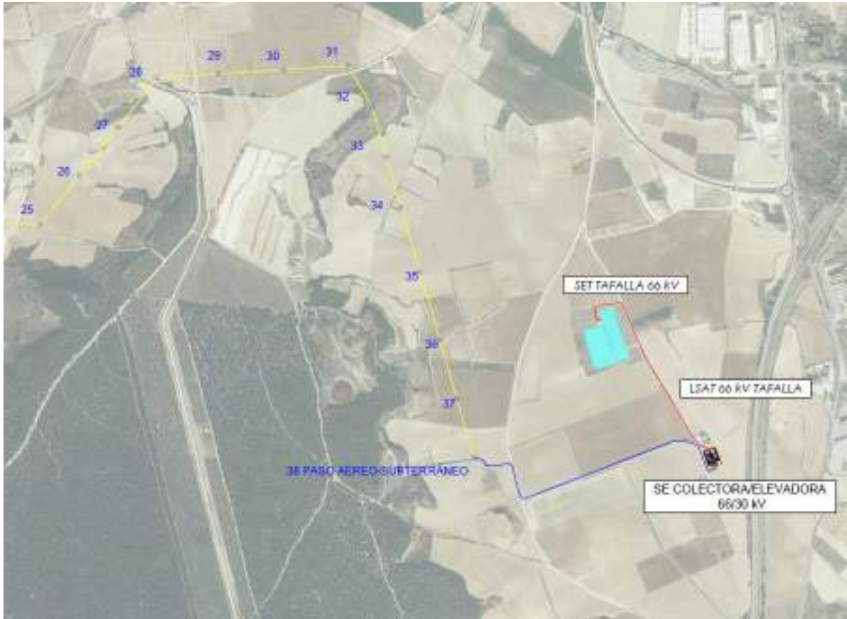
Imagen 16. Hoja 3: LASAT 66Kv aérea hasta apoyo 38, subterránea desde apoyo 38 a SE Colectora elevadora 66/30Kv y subterránea LSAT 66KV hasta SET TAFALLA 220/66KV
