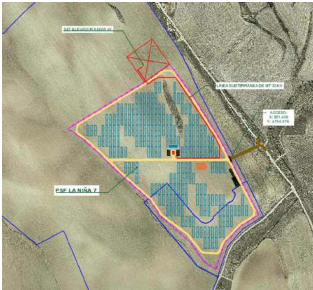
Imagen 8. Localización en rojo de la LSMT 30 kV.
