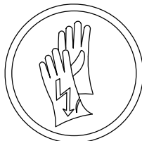
USO DE GUANTES DIELECTRICOS
