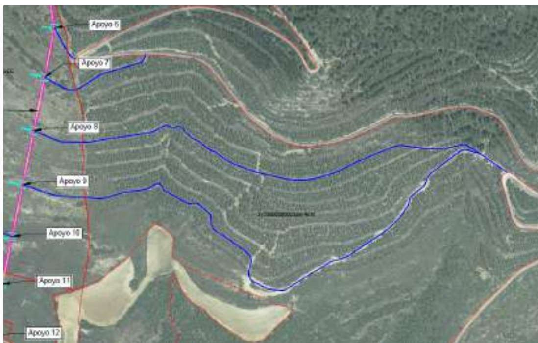
Ilustración 5. Caminos públicos para acceso a apoyos
