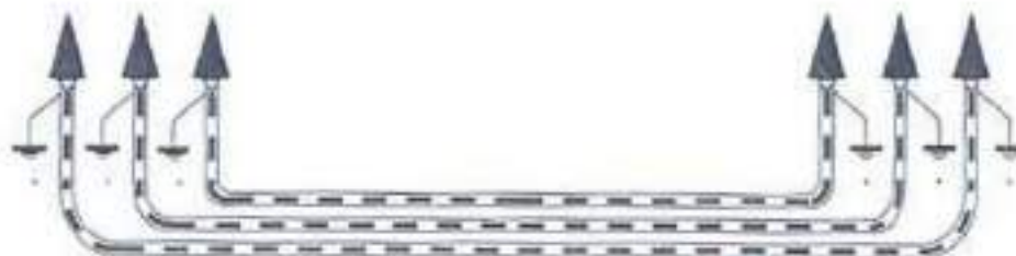
Ilustración 8. Puesta a tierra cubiertas metálicas
