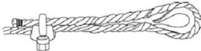
APLICACIÓN DE LA PRIMERA GRAPA: Se dejará una longitud de cable adecuada para poder aplicar las grapas en número y espaciamiento dados por la tabla. Se coloca la primera a una distancia de los extremos del cable igual a la anchura de la base de la grapa. La concavidad del perno en forma de U aprieta el extremo libre del cable. APRETAR LA TUERCA CON EL PAR RECOMENDADO.
