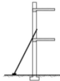
USAR ZAPATAS ANTIDESLIZANTES
