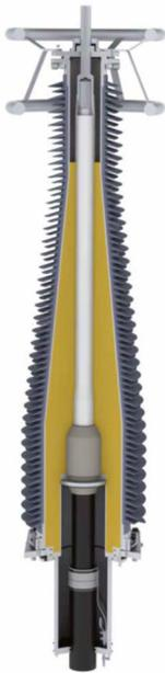
tienen el aislador de composite cementada a una base metálica de fundición que a su vez está soportada por una placa metálica. Esta placa está montada sobre aisladores de pedestal los cuales se apoyan en la estructura metálica de la torre. En el extremo superior, el arranque del conector está protegido por una pantalla contra las descargas parciales.
