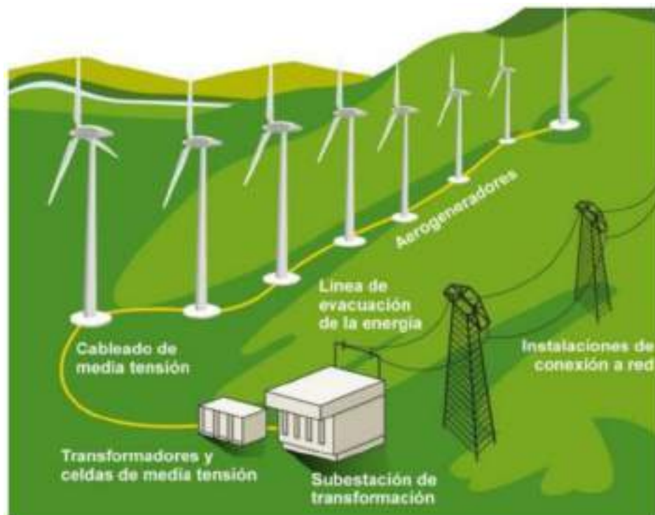
Imagen 3. Esquema de un Parque Eólico (Fuente: Greenpeace)
