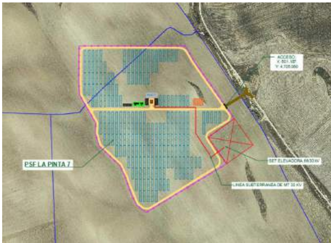
Imagen 2. Acceso a la Planta Solar
