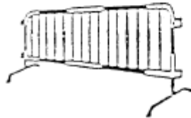
VALLAS DESVIO TRAFICO
