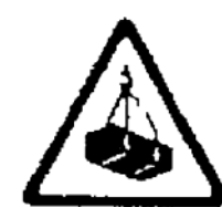
RIESGO DE CARGAS SUSPENDIDAS
