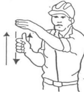
4 Levantar el aguilón o pluma lentamente
