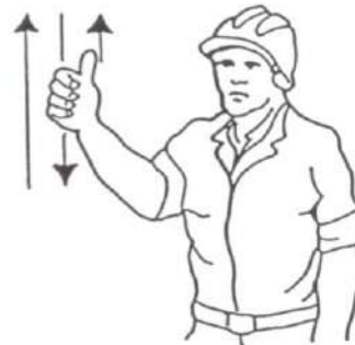
4 Levantar el aguilón o pluma lentamente
