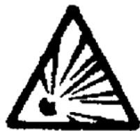
RIESGO DE EXPLOSION MATERIAL EXPLOSIVO
