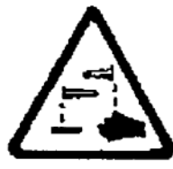
RIESGO DE CORROSION
