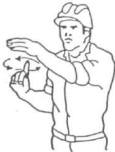
3 Levantar la carga lentamente
