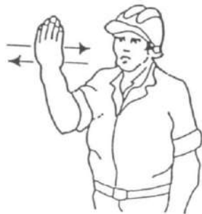
12 Avanzar en la dirección indicado por el señalista
