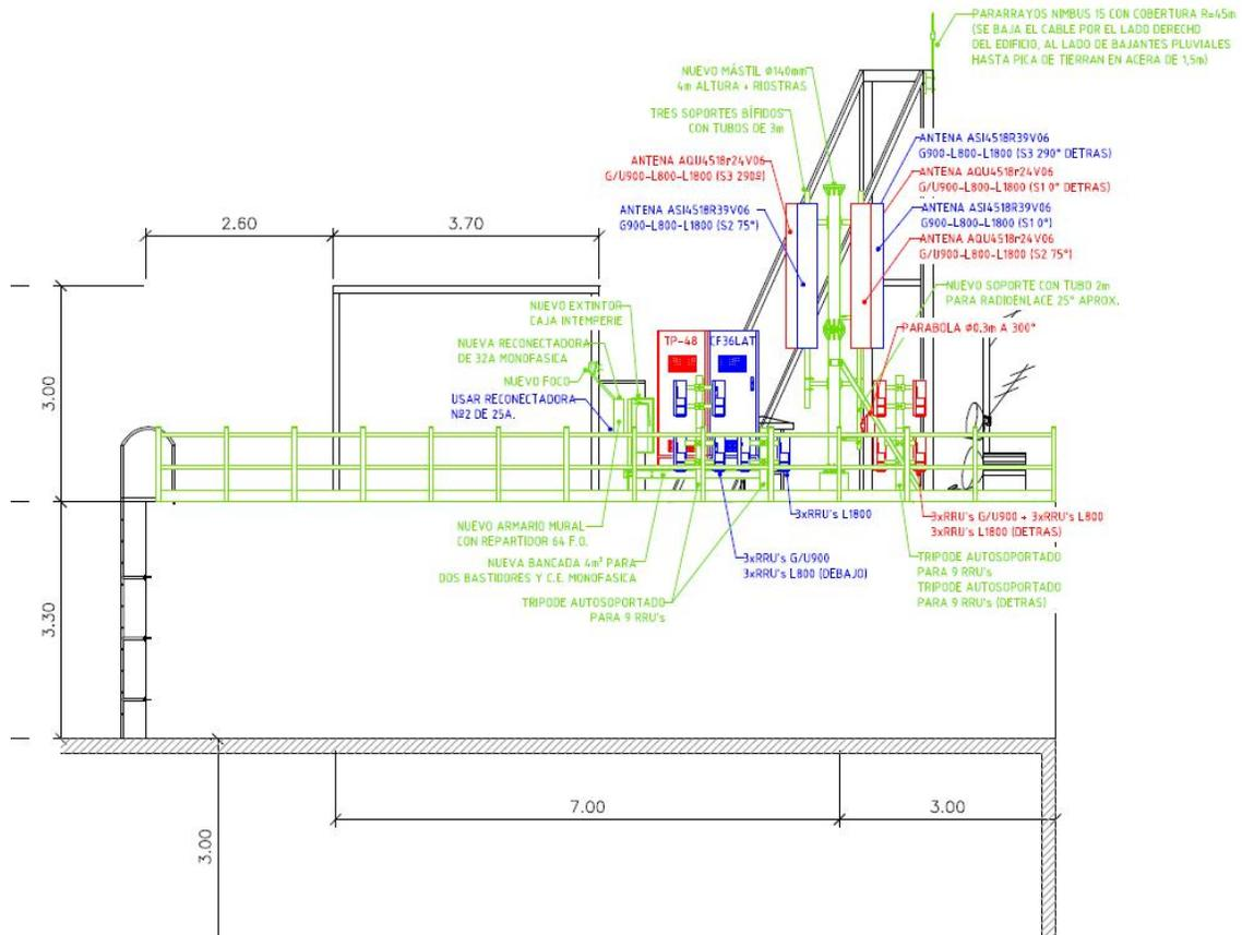
**Plano de alzado de la instalación**
