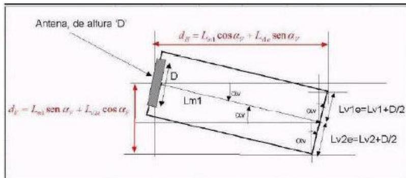
Definición del parabolenoide de referencia (efectivo).
