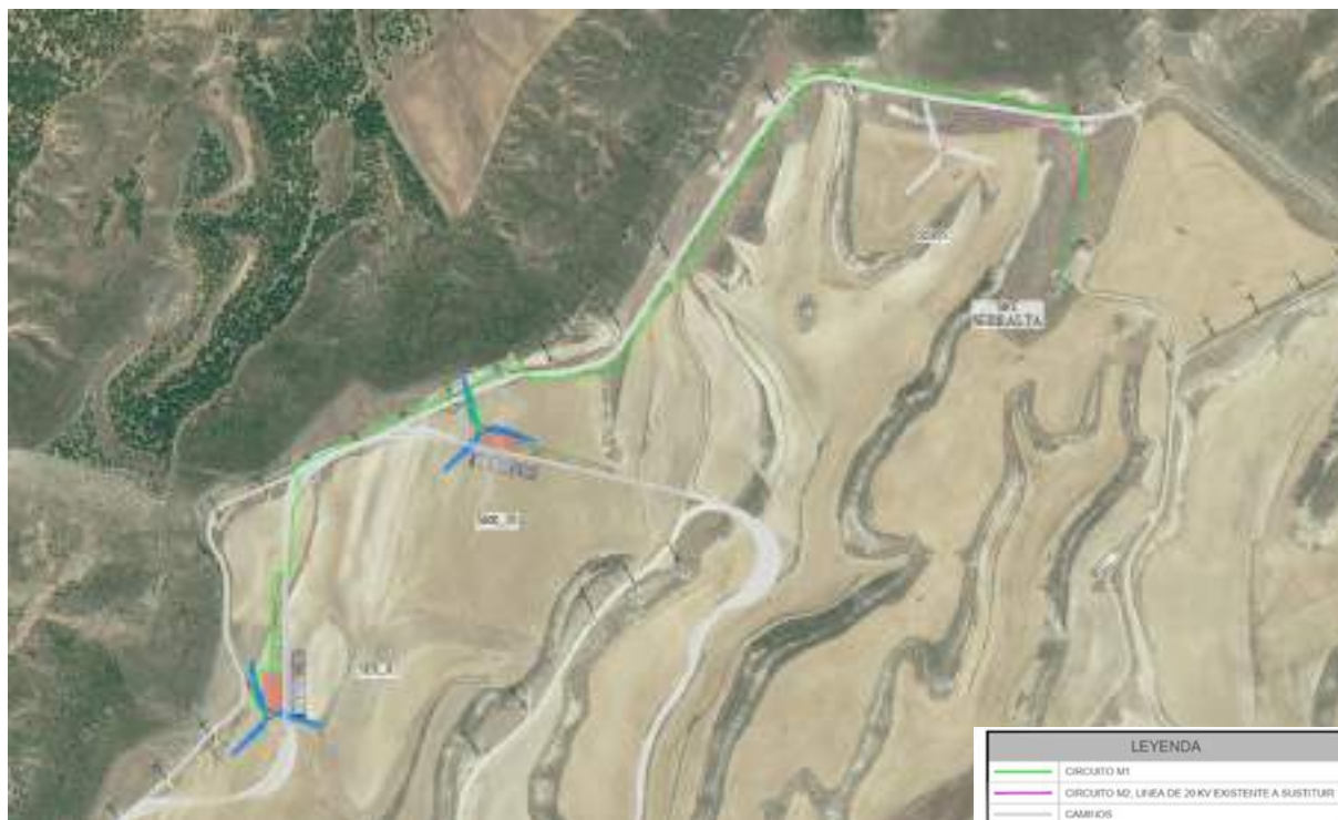
Imagen 11 distribución eléctrica aerogeneradores
