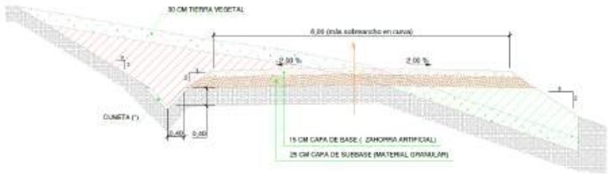
Imagen 4 Sección tipo material granular
