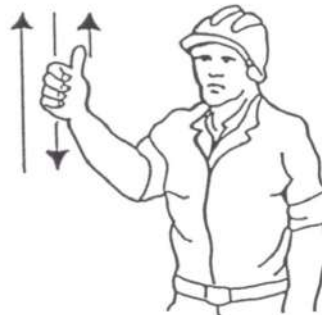
4 Levantar el aguilón o pluma lentamente
