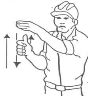
4 Levantar el aguilón o pluma lentamente
