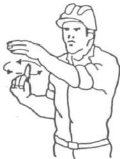
3 Levantar la carga lentamente
