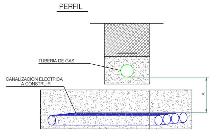
A: Distancia mínima 20 cm entre TUBERIA DE GAS y Tubo para cables de Baja Tensión.
