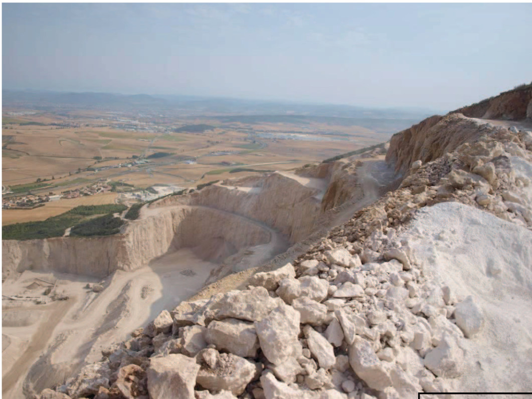
Fotografía 6.- Vista de la explotación en el norte de la cantera. Solo queda la roca alterada en los bancos que recientemente se ha comenzado a explotación.
