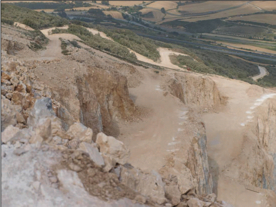
Fotografía 5.- Vista de los bancos superiores de la parte sur de la cantera. El delgado espesor de roca alterada ha desaparecido en el avance de las extracciones.
