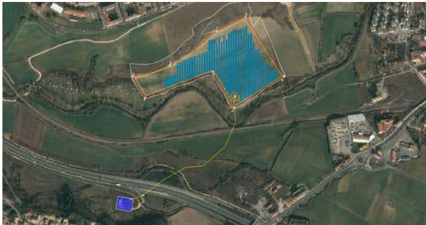
Figura 3. Situación de la línea de evacuación de la Planta Solar Fotovoltaica ISF ZIZUR.
