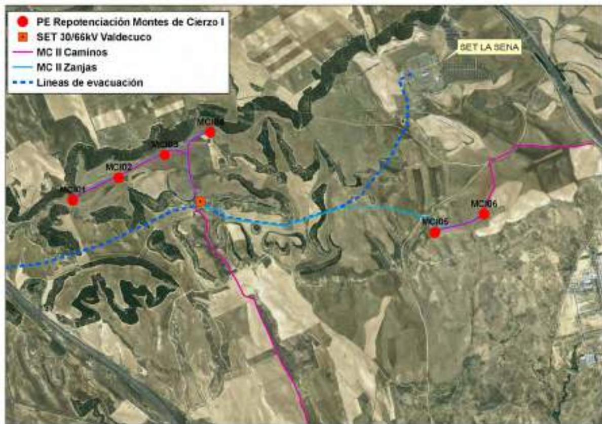
Imagen 2. Implantación de infraestructuras permanentes del parque eólico repotenciación Montes de Cierzo I
