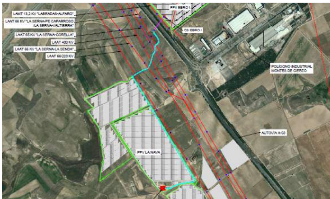
Figura 4. Esquema de la conexión eléctrica entre la “PSF Ebro I” y la “PSF La Nava”.
