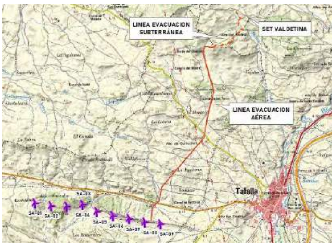
Imagen 1. Aerogeneradores y línea de evacuación.
