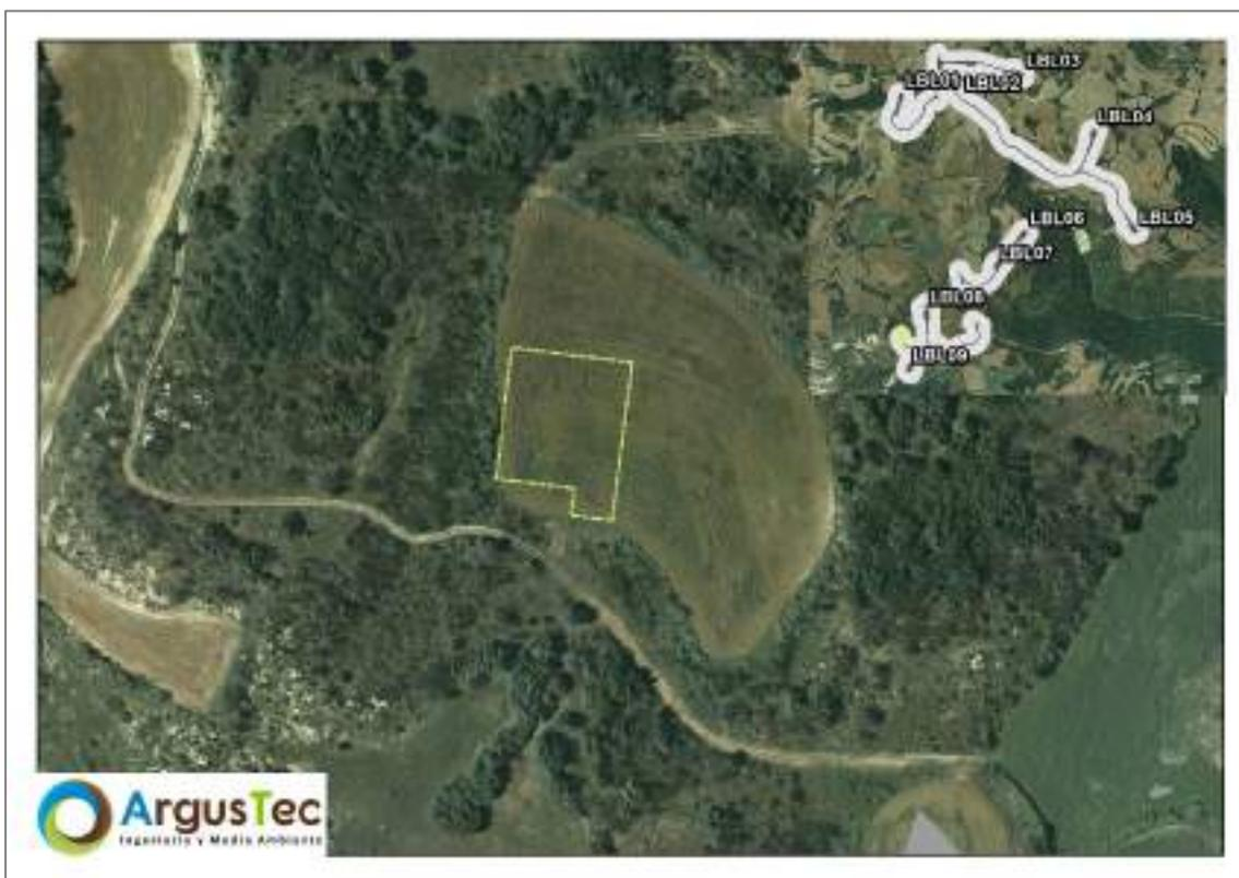
Otro factor a tener en cuenta, es la distancia con respecto a las posiciones de los aerogeneradores, puesto que estos estarán interconectados con la SET mediante zanjas, para elevar la tensión de los 30kV hasta los 132kV. Se ha realizado un análisis de distancias de cada una de las Alternativas con respecto a las posiciones de sus aerogeneradores, dando como resultado lo indicado en la siguiente tabla.
