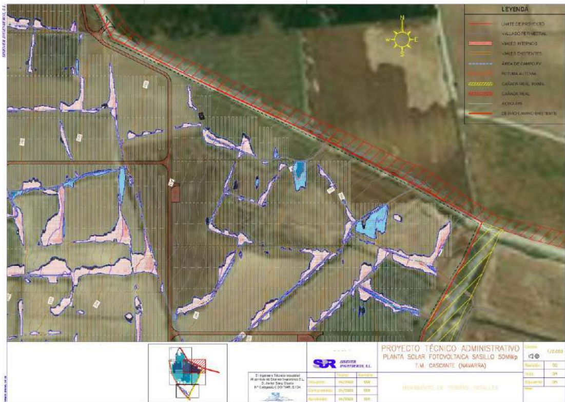
Imagen 49. movimientos de tierra a realizar en diferentes ubicaciones de la planta fotovoltaica.
