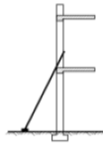
USAR ZAPATAS ANTIDESLIZANTES
