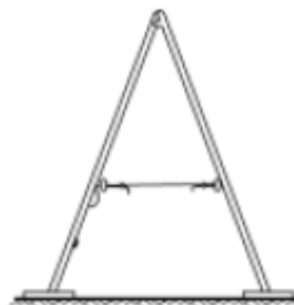
LAS ESCALERAS DE TIJERA DEBEN DISPONER DE CUERDA O CADENA Y DE ZAPATAS ANTIDESLIZANTES
