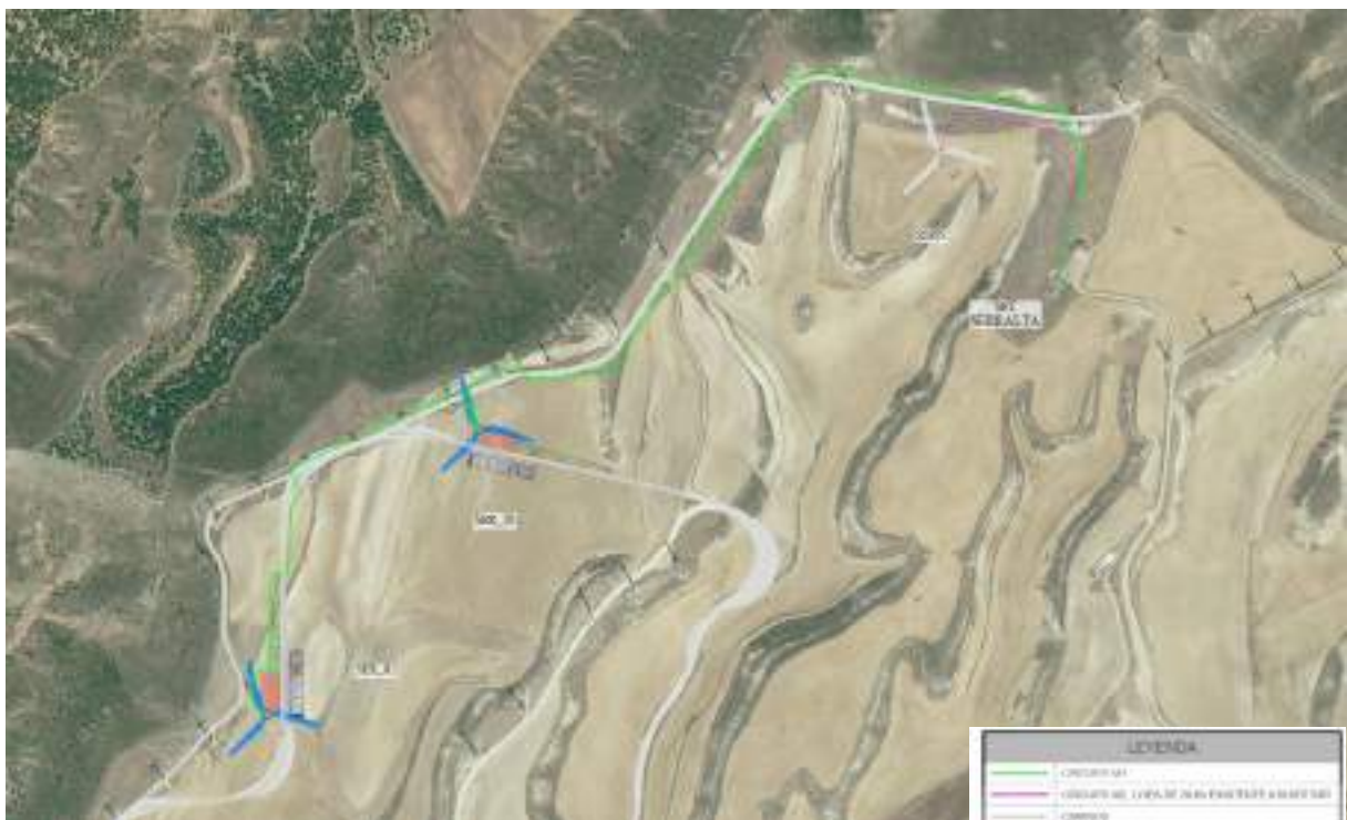
Imagen 11 distribución eléctrica aerogeneradores
