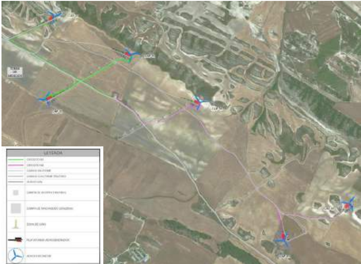
Imagen 11 Distribución eléctrica aerogeneradores
