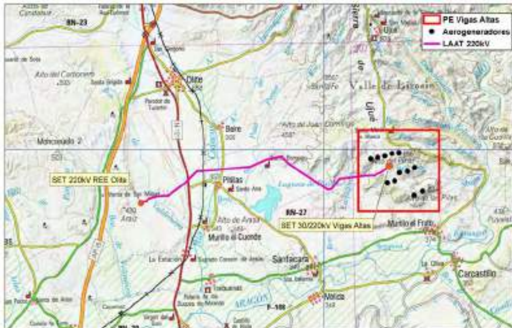
Imagen 1. Parque eólico Vigas Altas y sistema de evacuación
