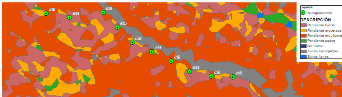
Figura 20. Pendientes de la zona del parque eólico
