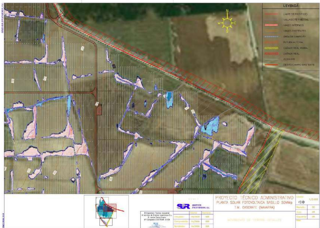
Imagen 39. movimientos de tierra a realizar en diferentes ubicaciones de la planta fotovoltaica.
