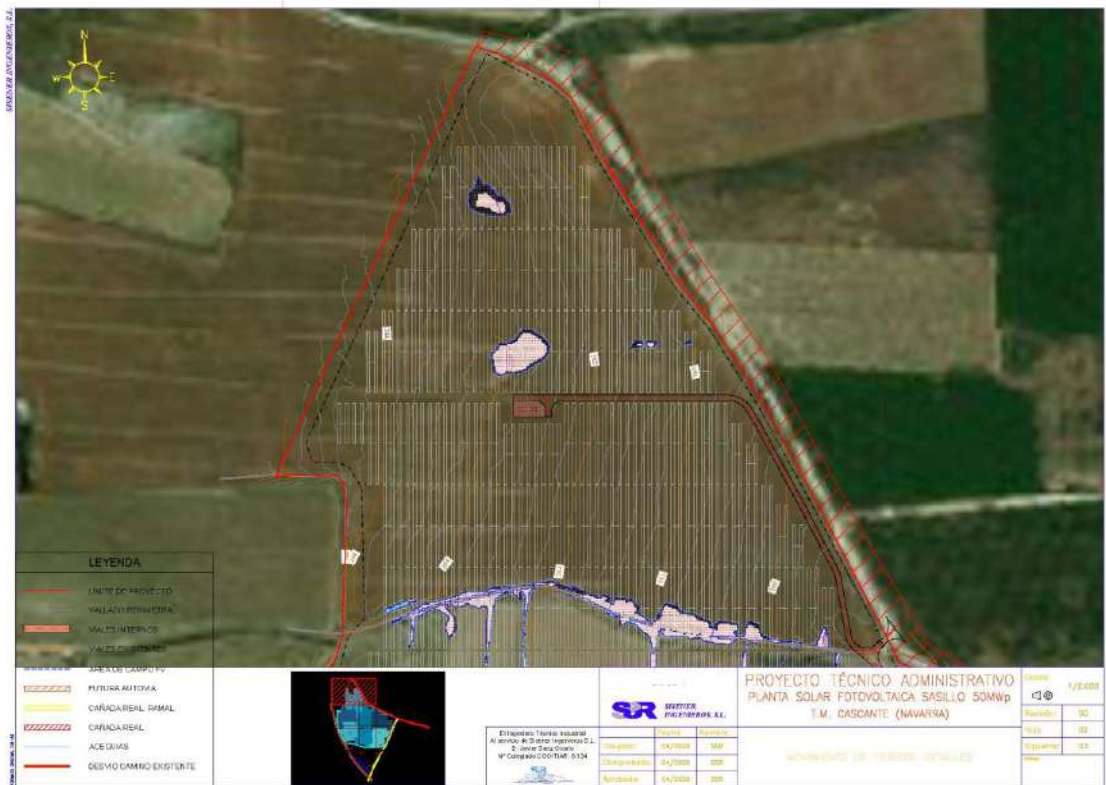
Imagen 37. movimientos de tierra a realizar en diferentes ubicaciones de la planta fotovoltaica.
