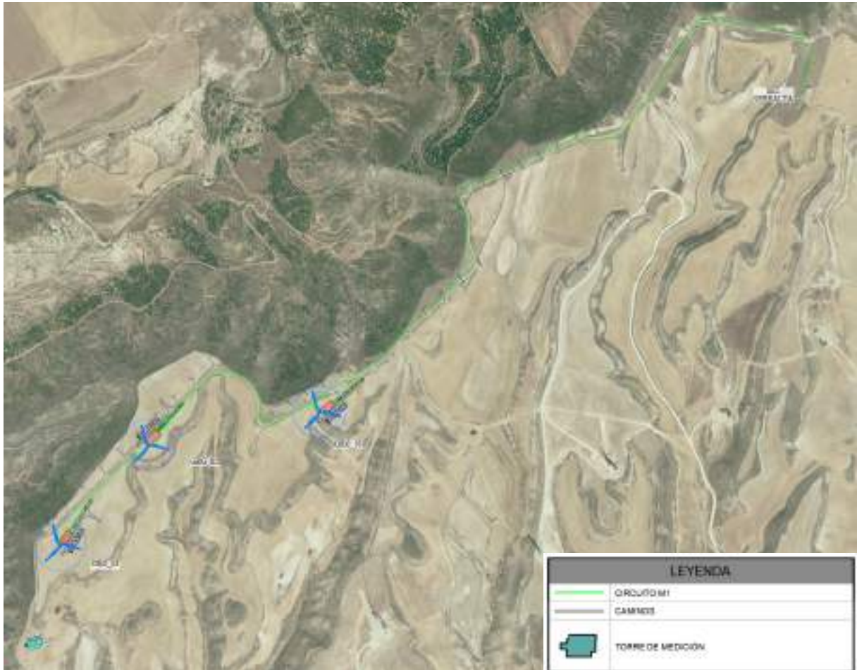
Imagen 11 distribución eléctrica aerogeneradores
