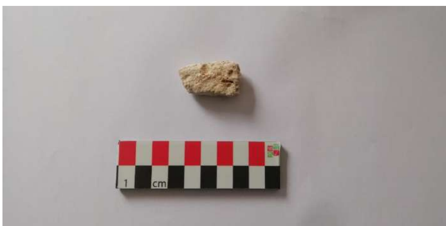
Imagen 90. Fragmento de mortero hidráulico. Ermita de San Sebastián.
