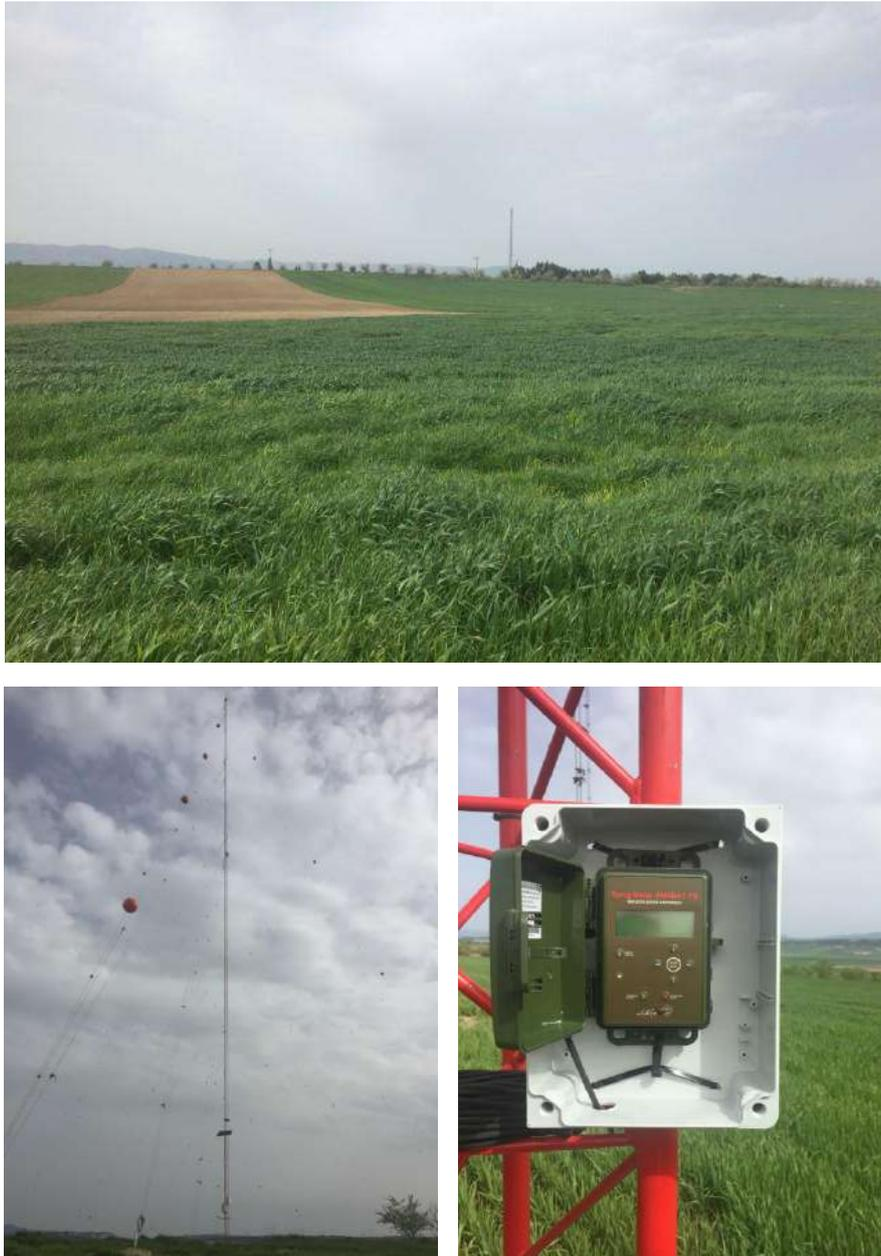
**Figura 4.** Zona de estudio. Arriba: paisaje de cultivos de cereal donde se encuentra la torre meteorológica en la que se ha instalado la grabadora de ultrasonidos. Abajo izquierda: torre meteorológica con el micrófono a 70 m sobre el suelo. Abajo derecha: armario con la grabadora de ultrasonidos en su interior.
