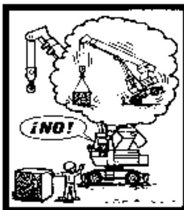
No sobrepasar la carga máxima de utilización, que debe estar bien visible, para los montacargas, grúas y demás aparatos de elevación.
