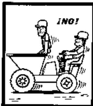
Está formalmente prohibido transportar a personal por medio de los montacargas, grúas y demás aparatos destinados únicamente al transporte de cargas.
